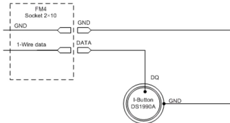
5 Figure Digital key “I-Button” DS1990A connection scheme
