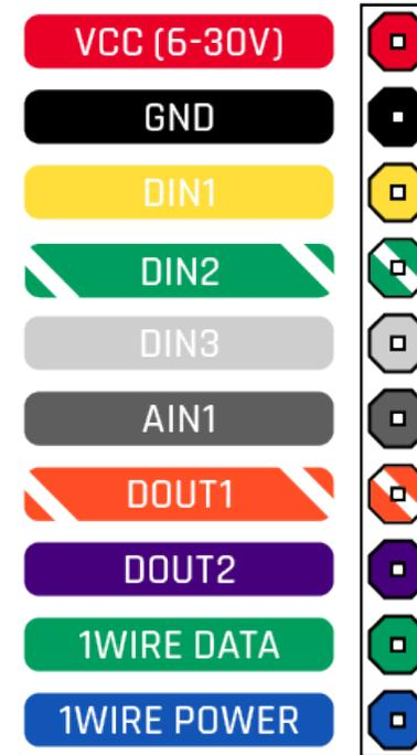
**Figure 2 FMB204 wires**
