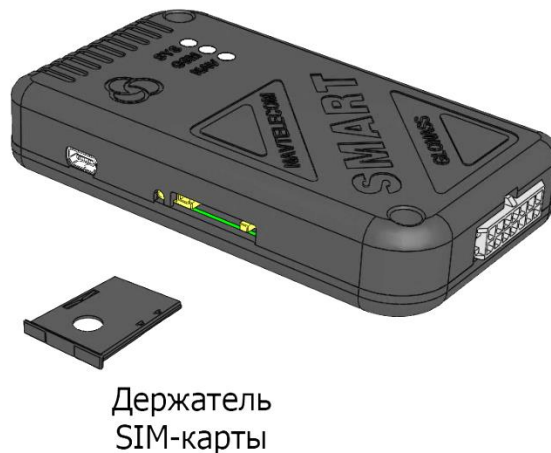
Рис. 21. Установка SIM-карты в устройство
